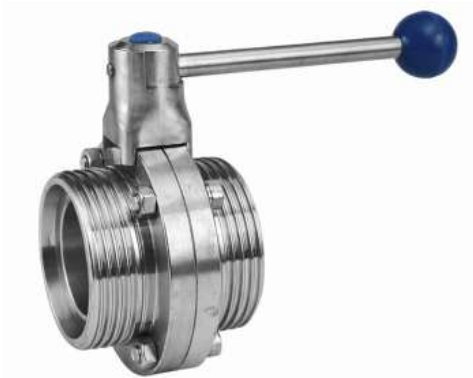
Дисковый затвор резьбовой AISI304, DN80 (3"), EDPM, DIN 11851, LTR-DZR80/4
