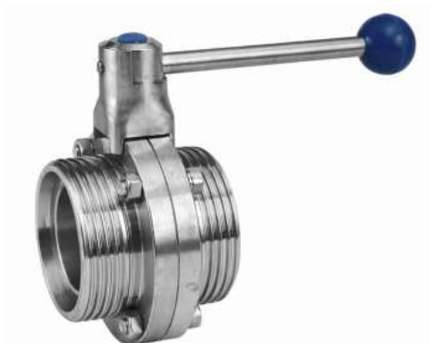
Дисковый затвор резьбовой AISI304, DN32 (1_1/4"), EDPM, DIN 11851, LTR-DZR32/4
