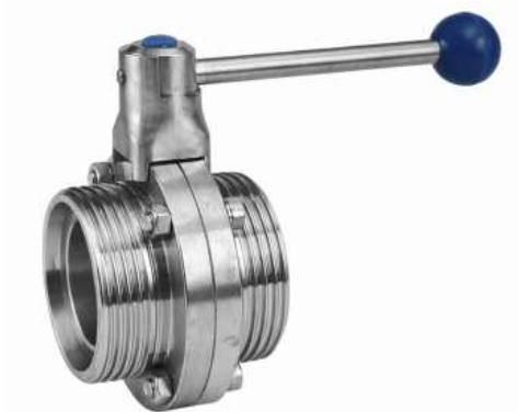
Дисковый затвор резьбовой AISI316, DN40 (1_1/2"), EDPM, DIN 11851, LTR-DZR40/6
